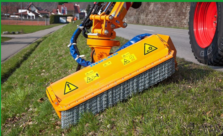
Tilt-/Schwenkeinrichtung zum Drehen und Neigen des Arbeitsgerätes
