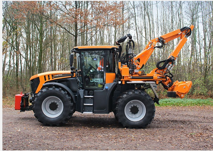
Heckausleger-Mähgerät GHA 700 JCB in Transportstellung
