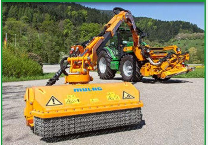
Die optionale Tilt-/Schwenkeinrichtung ermöglicht neben dem **Drehen von bis zu 240° des Arbeitsgerätes** um die Vertikalachse auch einen Ausgleich bei Mäharbeiten mit vorgeschwenktem Auslegerarm an Gegen- und Unterböschungen. Der Tiltwinkel beträgt jeweils 40 Grad nach links und rechts.
