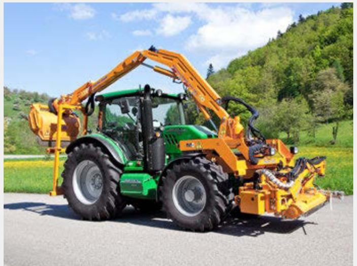
Durch die Ablage des Auslegers auf den heckseitigen Parkrahmen wird eine ausgewogene Achslastverteilung bei der Transportfahrt erzielt.
