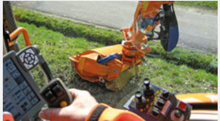
Das Auslegersystem mit dem Arbeitsgerät lässt sich optimal in den Sichtbereich des Bedieners nach vorne schwenken.
