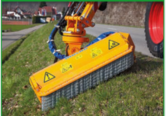
Die optionale Tilt-/Schwenkeinrichtung ermöglicht neben dem **Drehen des Arbeitsgerätes von bis zu 240°** um die Vertikalachse auch einen Ausgleich bei Mäharbeiten mit vorgeschwenktem Auslegerarm an Gegen- und Unterböschungen. **Der Tiltwinkel beträgt jeweils 50°** nach links und rechts.
