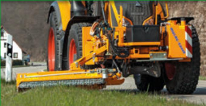
Das Randstreifenmähergerät MRS 300 ist ideal für das Ausmähen im straßennahen Bereich im Rechts- und Linksbetrieb. Aufgrund der niedrigen Bauhöhe ist das Gerät speziell für den Einsatz unter Schutzplanken geeignet. Durch die äußerst kompakte Konstruktion und den hochklappbaren Tastarm am MRS 300 wird ein **Vorbaumaß unter 3,5 m erreicht!** Der Mähkopf kann wahlweise mit zwei bewährten und am Markt etablierten Messerwellenkonzepten ausgestattet werden.
